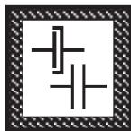
Flanschflächen schützen. Schrauben kreuzweise anziehen.
