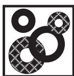
Grundsätzlich nach Teileausbau/-umbau neue Dichtungen verwenden.
